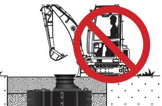
Pour le creusement de la fouille : faire attention à la hauteur et aux fils d'eau des différents appareils dans la préparation des fouilles. Le fond de l'excavation doit être mis de niveau.
